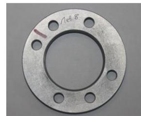
В зависимости от ориентации кондуктора происходит перенос отверстий на фланце шаровой опоры с правой и левой стороны моста, согласно маркировкам нанесенных электрическим карандашом «Лев» и «Прав» и величиной дополнительного (к штатному кастору) наклона. Если на Вашем автомобиле кастор, до изменения угла наклона был, к примеру, 2 градуса, то после пересверловки он станет 7 градусов (при использовании кондуктора +5) или +10 градусов (при использовании кондуктора +8).
